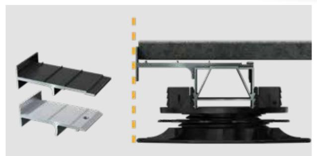
S-Fix / S-Fix-H für die seitliche Fixierung der Platten. Der 5 mm starke Alu-Winkel verhindert die Kippbewegung der Platten bei Kantenbelastung. Er hat die gleiche Tiefe wie der Terrassenlagerfuß, der deshalb beim Wandanschluss nicht eingekürzt werden muss.
