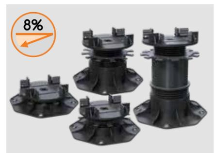
Terrassenlager-CLIP sind höhenverstellbar von 25 bis 225mm. Der nach allen Seiten bewegliche Aufsatz gleicht Gefälle des Untergrundes bis zu 8 % aus.
