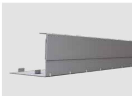
Seitenverkleidung aus strukturgepulvertem Aluminium, die nicht am Boden befestigt werden muss. Hat einen Kantenschutz und kann flexibel Bodenunebenheiten ausgleichen. Höhe 69-113 mm & 105-149 mm
