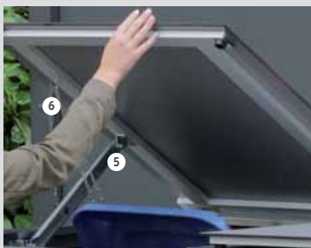
Variante mit Klappdeckel: Einhandbedienung durch Teleskopaufsteller (5) (hält den Deckel offen), Zugkette (6) öffnet den Tonnendeckel „automatisch“.
