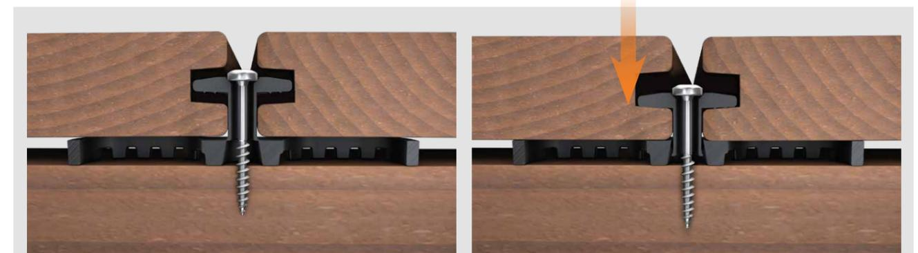
Flexibler Spannungsbereich von 6 mm durch Sollbruchstelle.
